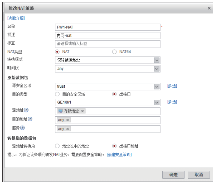
图2-3-28-9 创建NAT策略（配置内容按照图中填写）
